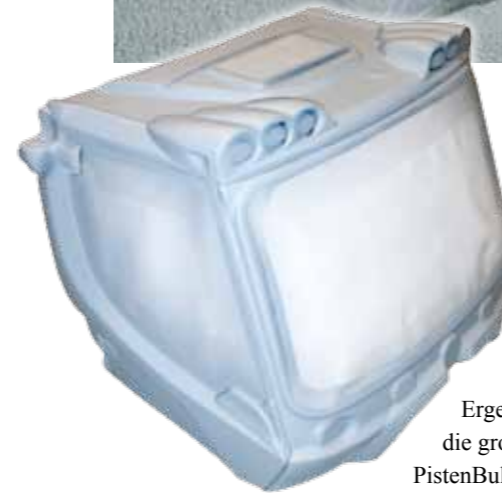
Abkleben der Fahrerkabine und hellgraue Grundierung
