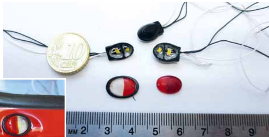
Kombileuchten mit eingelöteten Micro-LED
