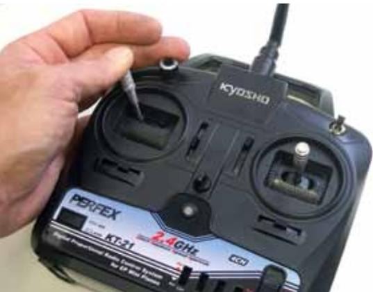
Die Fahrbewegung liegt in der Knüppeldiagonale. Das Bild zeigt Vollgas vorwärts. Darüber das Poti zur Heckträgeransteuerung
