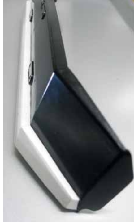
Eine kleine Maßnahme mit großer Wirkung: Die Gleitkufe am Frontschild
