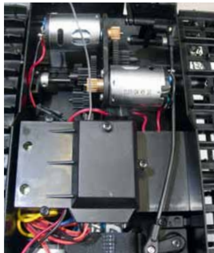
Der Antrieb nach dem ersten Umbauschritt. Gut zu sehen ist die abgekröpfte Steuerstange zum Frontschild
