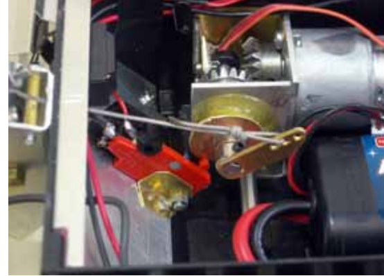
Technisch anspruchsvoll: der Seilzug zum Heckträger und der Automatikschalter zur Stromzufuhr
