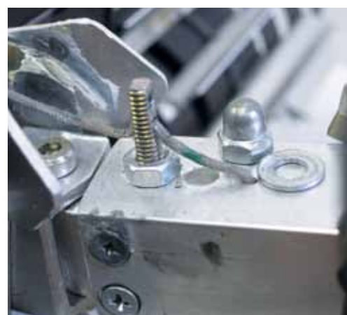
Die einfache, aber dennoch sehr sichere Klemmbefestigung des Zugseils am Heckträger
