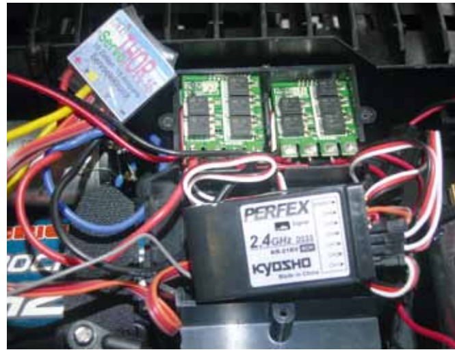
Ein separater Empfänger mit steckbarer Elektronik ist ein großer Pluspunkt für eigene Erweiterungen am Modell
