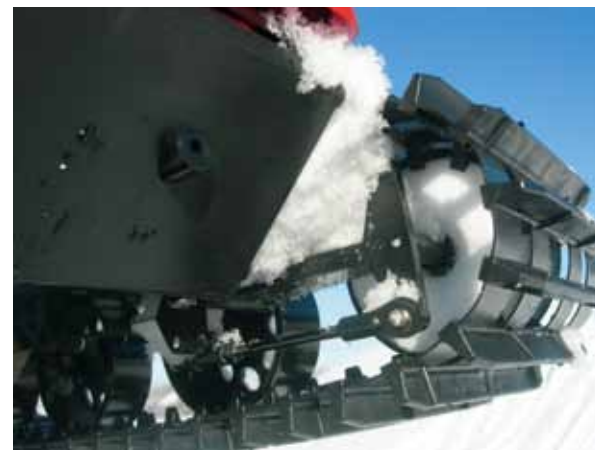
Auf der ungewöhnlich konstruierten Spannradaufhängung lagert sich gerne der Schnee ab und behindert einen optimalen Schneeeabfluss auf der Ketteninnenseite
