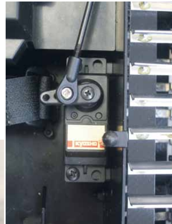
Eine 50-Prozent-Wegverkürzung am Servohorn bedeutet 50 Prozent mehr Kraft, die auch dringend nötig ist
