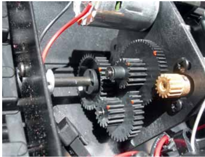
Das kompakte Doppelgetriebe mit den fixen Stehbolzen ist – mit Ausnahme des Motorritzels – komplett in Kunststoff gehalten
