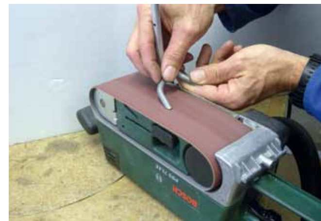
Mit Sorgfalt werden die Tragrohre an den Fräsenkasten angepasst
