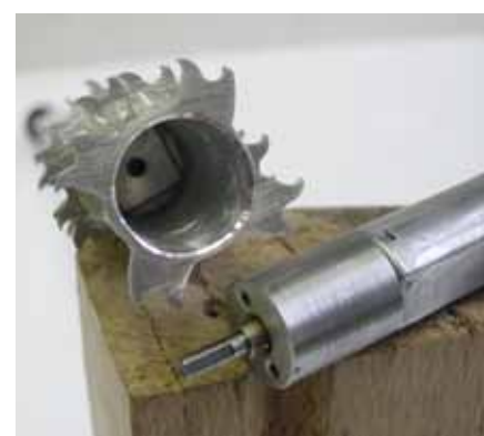
Blick ins Welleninnere, wo eine zentrische Bohrung die Motorwelle aufnimmt
