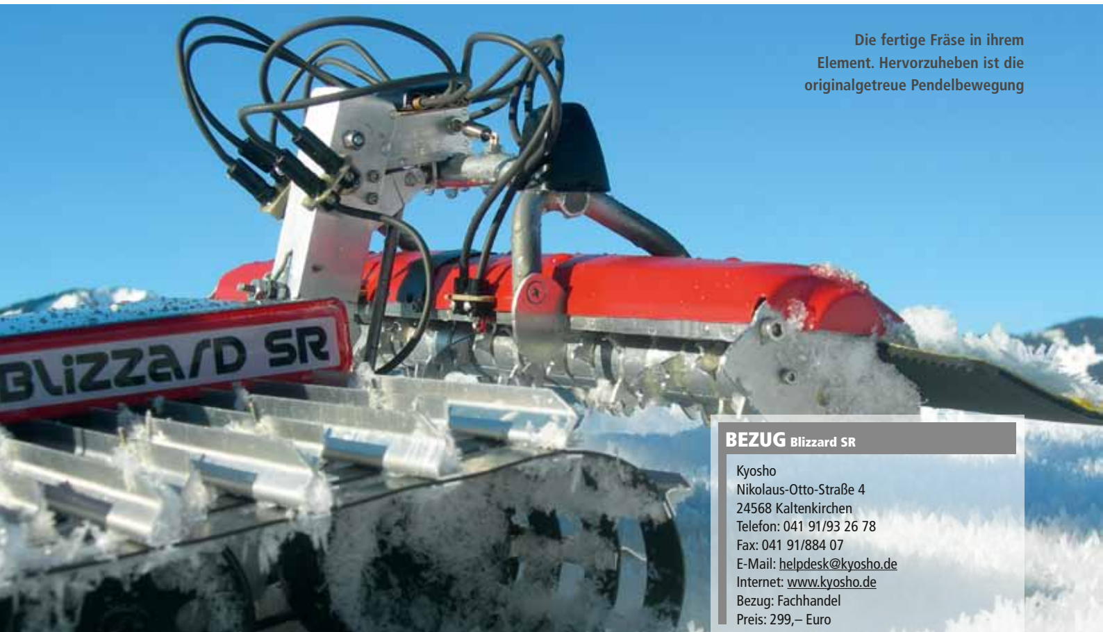
Die Fahrbewegung liegt in der Knüppeldiagonale. Das Bild zeigt Vollgas vorwärts. Darüber das Poti zur Heckträgeransteuerung
