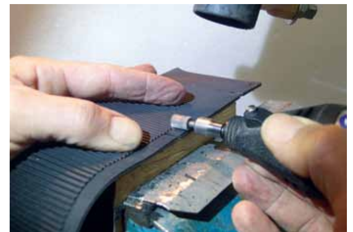
Das Abfräsen der Finisher-Rillen funktioniert per Dremel prima
